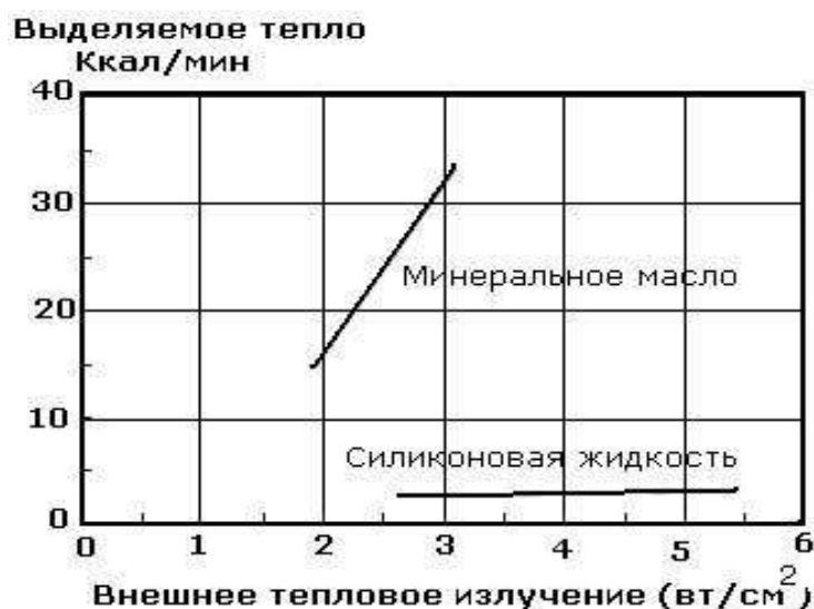
Рис.2 «Выделяемое тепло при горении минерального масла и силиконовой жидкости в зависимости от значения внешнего дополнительного воздействия».
