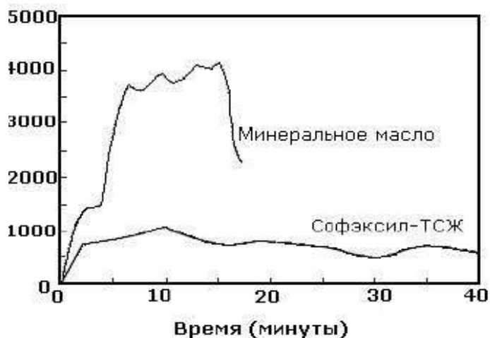
Рис.4 «Скорость выделения тепла в BTU/мин при возгорании различных жидкостей в бассейне диаметром 3 метра».
